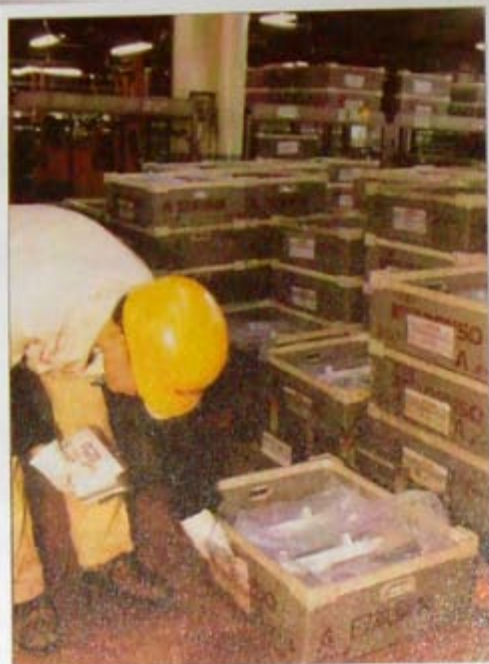
〈照片9〉作業員在零件工廠完成品倉庫中更換看板的情形。
