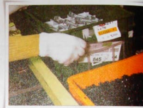
〈照片2〉領取零件的同時，貼上生產指示看板。
