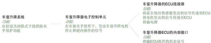
图 4.3-1 含功能结构树的结构树示例
