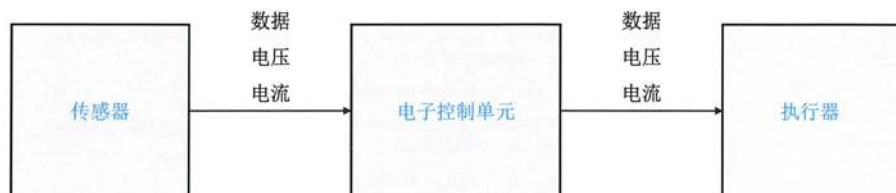
图 4.1-1 电气/电子/可编程电子系统的一般方块图
