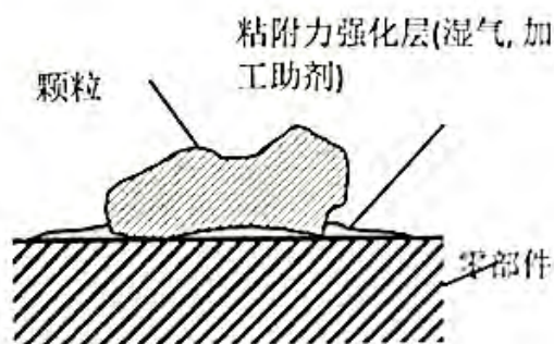
图 3-1 :颗粒通过粘附力附着在零件表面
